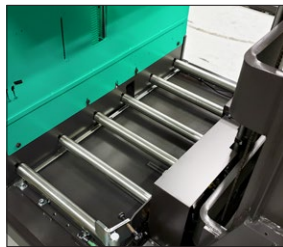
Batterie auf Stahlrollen
