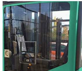
2-Wege-Sprechanlage und Fensteröffnung für beheizte Kabine
