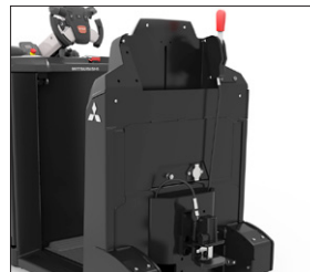
Automatische Kupplung mit ergonomischem Entriegelungsgriff
